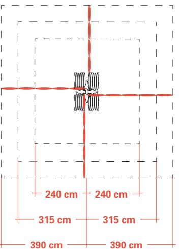
**(D)** Eine Säule mit vier gefalteten Wandpaketen à 5 Elementen benötigt eine Stellfläche von ca. 106 x 168 cm = 1,78 m<sup>2</sup>. Aufgeklappt unterteilen:
